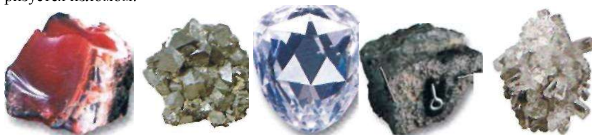
Рис.32. Физические свойства минералов. Кварц (неровный и раковистый излом). Галенит (совершенная спайность). Алмаз (твердость равна 9). Магнетит (магнитность). Кальцит (совершенная спайность в трех направлениях)
